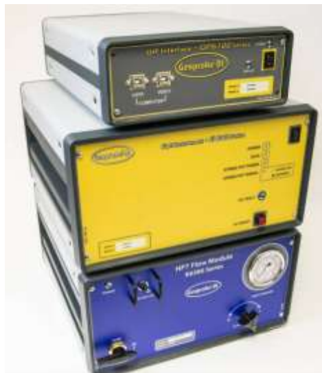
Figura 6 – Equipamentos OIP. 1 - Interface do OIP; 2 - Módulo de aquisição de dados; 3 - Controlador do HPT
